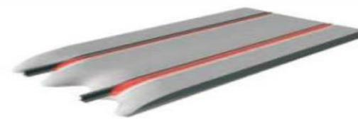
\*Os elementos marcados a vermelho fornecem à via uma rigidez equivalente à conferida pelo balastro.
