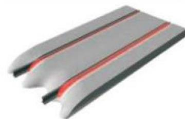
\*Os elementos marcados a vermelho fornecem à via uma rigidez equivalente à conferida pelo balastro.
