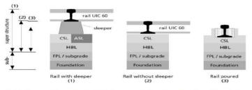
CSL - laje de betão (Concrete Supportive Layer); ASL — camada de mistura betuminosa (Asphalt Supportive Layer); HBL - agregados tratados com ligante hidráulico (Hydraulically-Bonded Layer); FPL - Camada de protecção contra o gelo (Frost protection layer); subgrade — leito de via.
