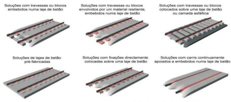
\*Os elementos marcados a vermelho fornecem à via uma rigidez equivalente à conferida pelo balastro.
